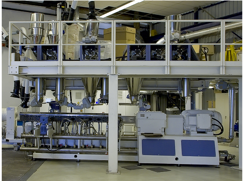
Bild 2: Henschel Compoundieranlage mit RHC 55 im Technikum der Zeppelin Reimelt GmbH, Kassel
